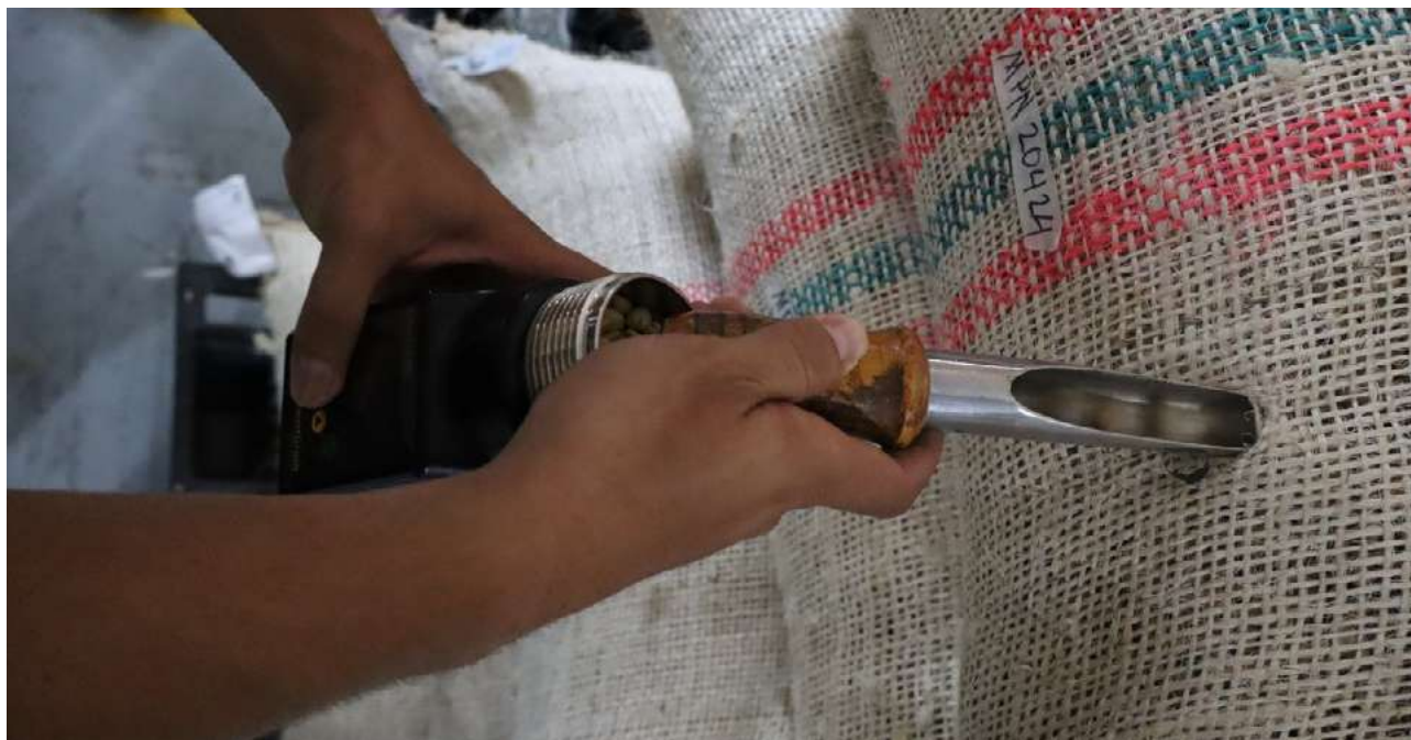
Imagen 3. Prueba de humedad para el café verde.
