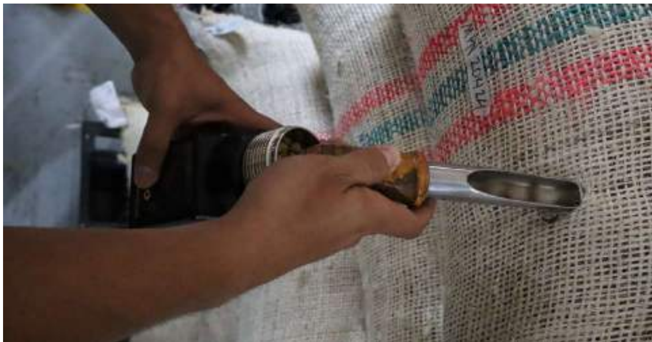
Imagen 3. Prueba de humedad para el café verde.
