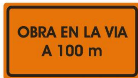
Ilustración 40. SIO-01 Aproximación a obra en la vía
