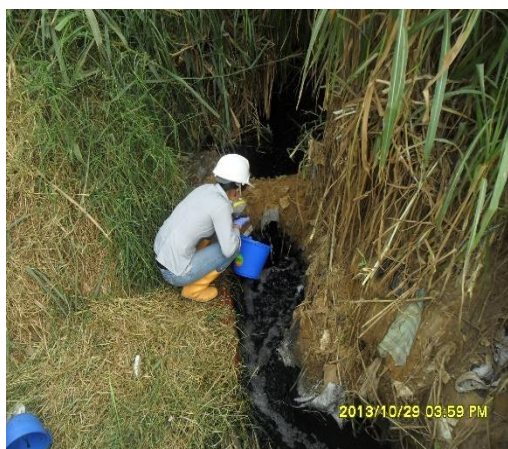
Aforo del caudal en el vertimiento final
