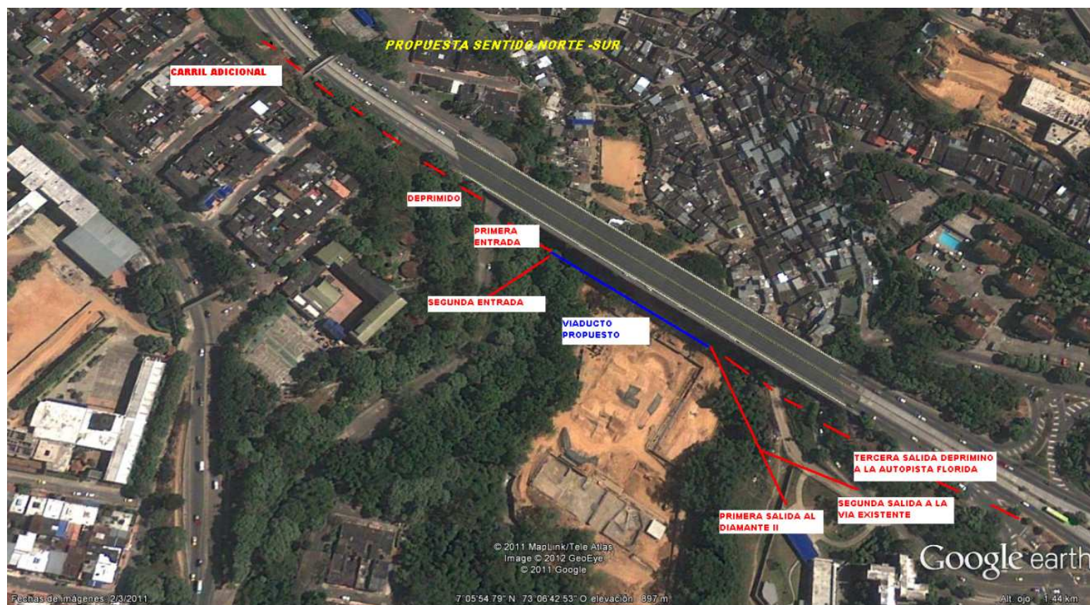
Figura 28 Esquema General de la alternativa No. 2 Sentido Norte-Sur
