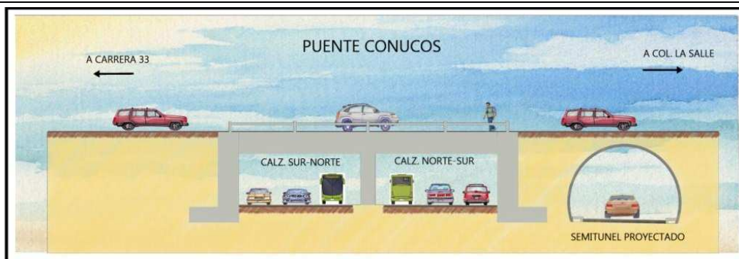
Figura 22. Semitúnel por el puente conucos sentido Norte-sur
